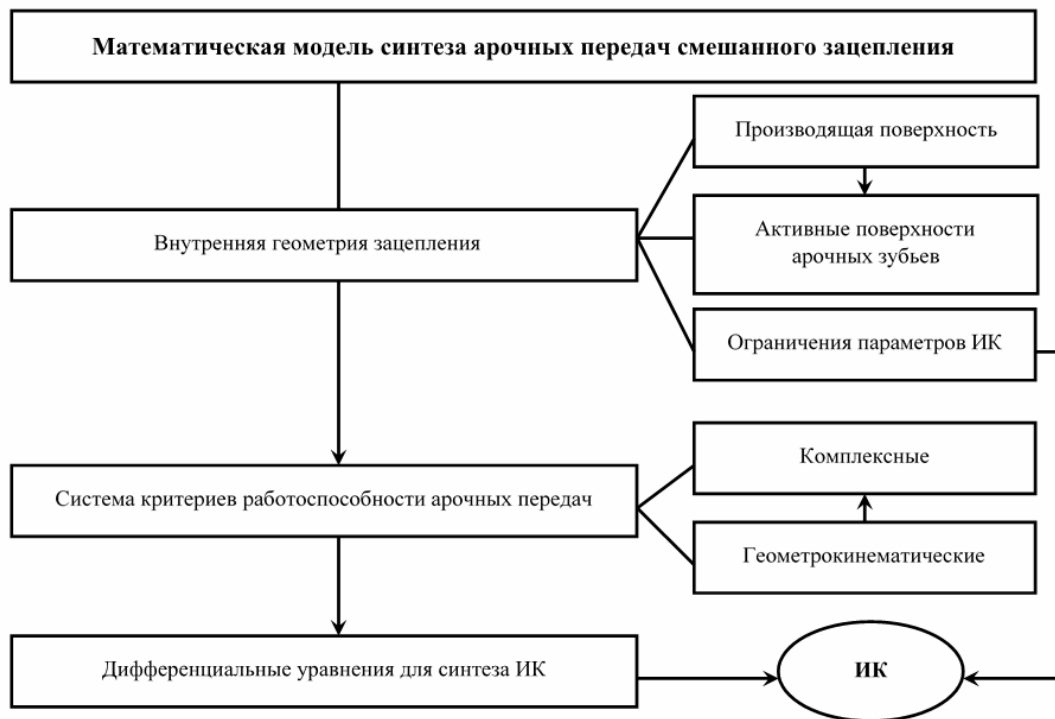
Рисунок 2. Структура математической модели синтеза процесса формообразования арочных передач смешанного зацепления
