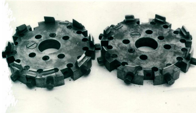
Рисунок 1. Резцовые головки с наружными (слева) и внутренними (справа) резами
